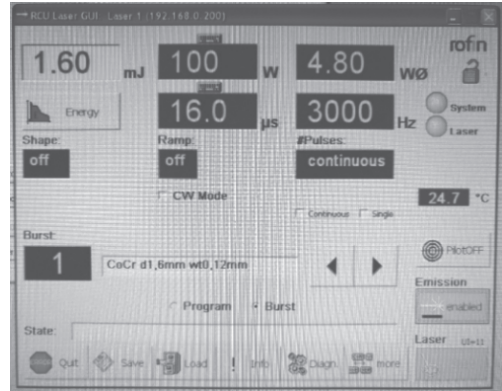
Рис. 14. Параметры лазерного излучения процесса резки внутрисосудистого стента
