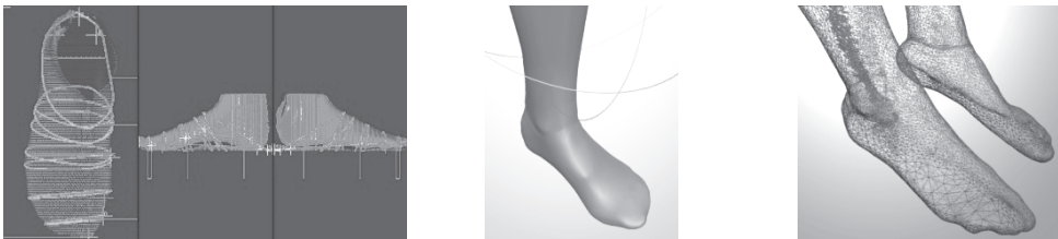
Рис. 1. Визуализация входной антропометрической информации о стопах со сканирующих устройств а — 3D Scanner HUMAN SOLUTIONS [21]; б — 3D сенсор Kinect [22]; в — 3D сканер Artec 3D Eva [23].
