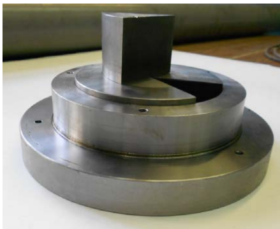
Рис. 27. Оснастка, предназначенная для проведения эксперимента по пластической осадке тонкой полосы формы сектора в плане
